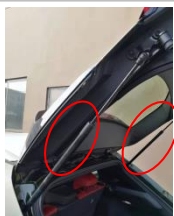
2.1 拆原车气弹簧，把原车左右两边气弹簧拆卸，提示：拆原车撑杆时需有人撑起尾门，防止掉下；
