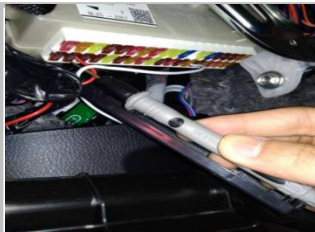
3.11 解码器正极:主驾位,A柱保 险盒,如图第二个保险丝
