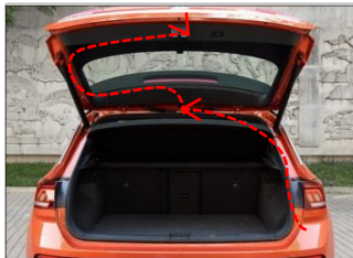
3.1 拆卸上门锁盖板,然后把电源线 和驱动盒线,解码器控制线如 虚线通过胶塞穿到上门锁盖板
