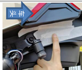
2.6 如上图锁指位置，打直径 19 圆孔，调整电机线长度，把防水胶塞卡进原车孔；右边同样方法安装
