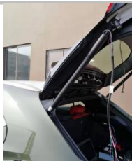
2.5 把我司撑杆如图示意卡进原车固定头内，并确保卡稳，如图左侧已装好，右侧同样方法安装
