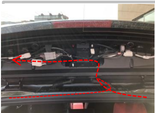
3.4 电源线、驱动盒线、解码器控制 线:穿过原车进线胶塞,
