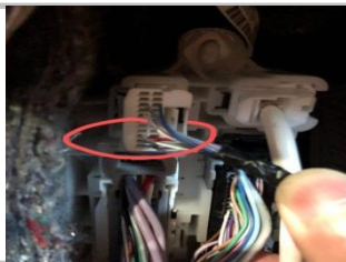
3.14 解码器 CAN 接线位置，主驾 A 柱，如图白色插头
