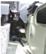
1.4 拆除尾箱右侧内饰板；注意：保护卡扣
