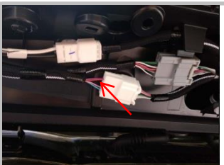
3.9 解码器控制线:原车红色线接解 码器线束灰色线;
