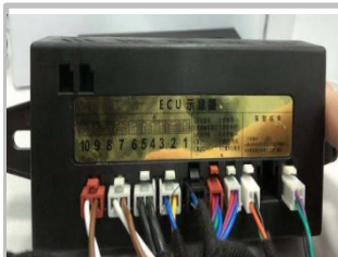
3.19 连接 ECU，待所有线束插好，最后插电源线插头；(插头如前面 ECU 插头说明示意图)
